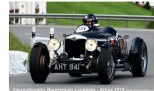
Seit der abgeschlossenen Restauration 2013 ist dieser «Special» an vielen Veranstaltungen zu bestaunen. Die historisch belegte Doppelbereifung an der Hinterachse verleiht trotz leicht höherem Gewicht zu mehr Traktion, besonders beim Start.
