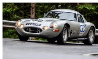
Die Lightweight-Version des Jaguar E wurde speziell für den Rennsport aus Aluminium gebaut. Die Motorleistung wurde auf 330 PS angehoben. Die windschlüpfrige Low Drag-Karosserie wurde vom Jaguar
